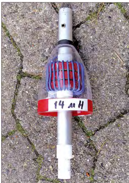
Bild 1: Beispiel für eine Verlängerungsspule mit Eisenpulver-Ringkern und L = 14 \mu\text{H}
