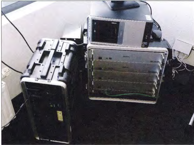
Der Messerepeater auf der Ham Radio 2015, bestehend aus den Icom-Modulen für 2 m, 70 cm und 23 cm (v.l.n.r.) und der Hytera – sowie im Hintergrund der Motorola-Umsetzer
