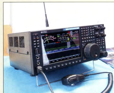
Der seit dem Vorjahr weiterentwickelte SDR-Transceiver MB1 (90 kHz bis 65 MHz und 95 MHz bis 148 MHz) des russischen Herstellers Expert Electronics soll in Deutschland bald bei Difona und WiMo erhältlich sein.
