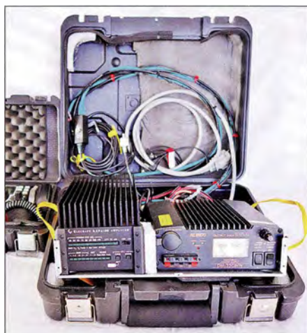
Bild 9: Elecraft KXPA 100, KXAT 100 und Netzteil Alinco DM-330MW im ABS-Koffer - auf dem Chassis eines analogen Sat-Receivers fixiert; Letzteres ist an den seitlichen Trageschlaufen herausnehmbar.
