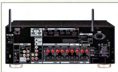
Vielfältige Verbindungen auf der Rückseite des VSX-930 von Pioneer
