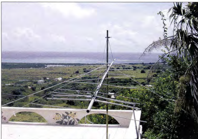
NP2X arbeitet mit 100 W an einer in Richtung Portugal ausgerichteten 15-Element-Yagi-Antenne
