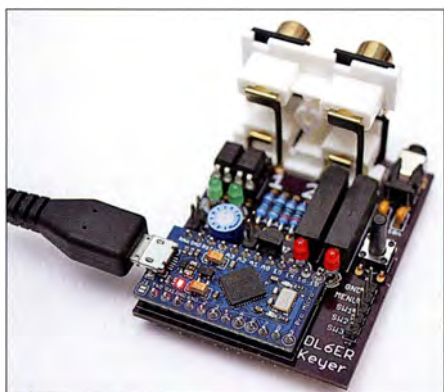
Bild 1: Morse-Keyer in der Variante „Small“; vorn ist das aufgesteckte Arduino-Modul Pro Micro von Sparkfun zu sehen, das über eine eigene Mikro-USB-Buchse zur Verbindung mit einem PC verfügt.
