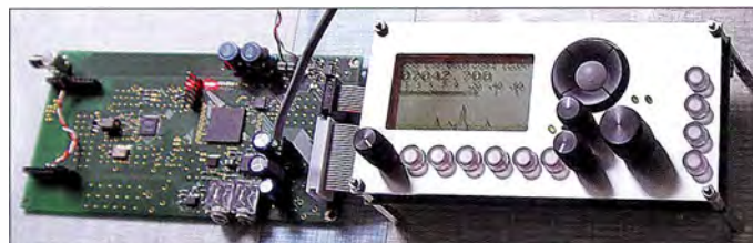
Zu Anschauungszwecken zerlegter SDR-Transceiver mit Spektrumanzeige von DM5KL
