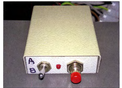
Bild 2: Das Steuergerät besitzt an der Frontseite nur einen Taster zum Starten des Abstimmvorgangs und einen Kippschalter für die Auswahl der Antenne.
