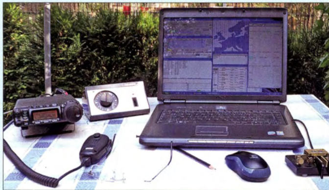
Bild 1: An warmen Tagen macht der Funkbetrieb auch draußen Spaß – hier „quasiportabel“ im Garten. Der Transceiver ist ein Yaesu FT-857D mit 50 W Sendeleistung und das Loggen erfolgt mit einem Notebook.
