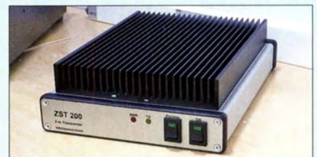
Bild 3: Taurfrisch von der Ham Radio – der im Herbst lieferbare 2-m/10-m-Transverter ZST-200 von SSB-Electronic mit 25 W Sendeleistung und 2,2 dB Empfangs-Rauschmaß
