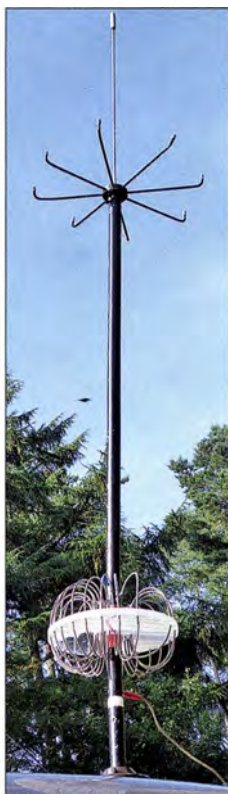
Bild 4 (oben): Damit der Toroid mit Luft als Kernmaterial eine Induktivität von L = 14 \mu\text{H} erreicht, sind bei einem Scheibendurchmesser von 220 mm insgesamt 21 Windungen erforderlich.
