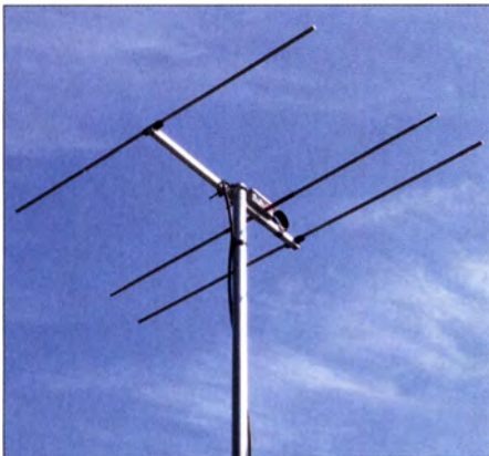
Bild 1: 3-Element-Yagi für 144 MHz mit 12,5 \Omega Impedanz und sehr eng gesetztem Reflektor
